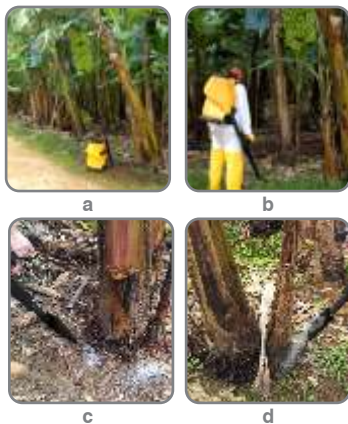
Figura 30. Aplicador Dorsal de Granulados (ACG) – Aplica dosis que varían de 8 a 285g; En las imágenes (c; d) regulado para aplicación de nematocida granulado en la dosis de 10 g por accionamiento del gatillo.
