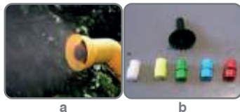
Figura 10. (a) bocal atomizador em uso (b) pontas dosadoras de vazão codificada por cores (de 200 a 2500 ml/min da esquerda para a direita) e alargador (cor preta).
