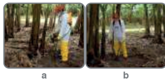
Figura 17. Dosificador de Grânulos Manual (DGM) – Aplica doses de 1,5 a 12g, até 5cm de profundidade no solo.
